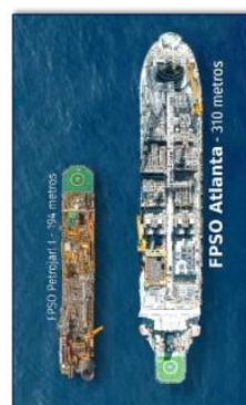
Comparação entre o FPSO Petrojarl I do SPA e o FPSO Atlanta do SD
